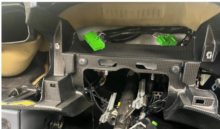
p. 取り外しと逆の手順で、オーディオユニット・ステアリングコラム・両側ピラーガーニッシュ・カウルサイドライニングを取り付けします。
