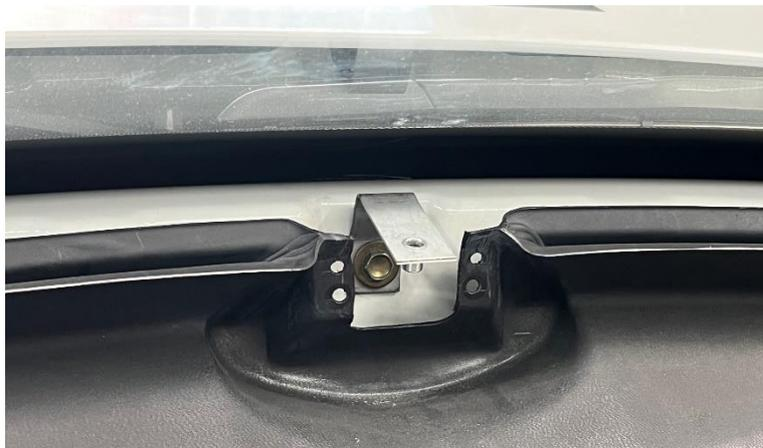
k. ステアを製作して、カーボンダッシュボード真ん中の止め点を固定します。
